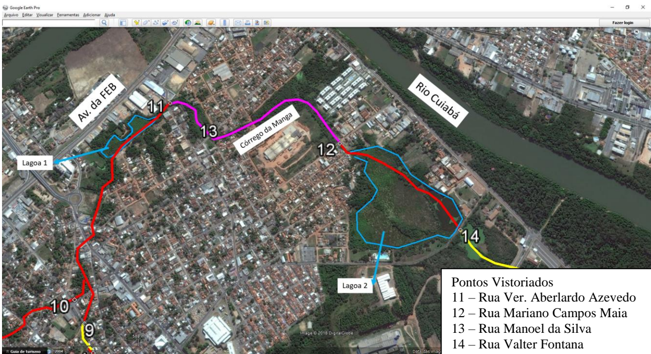
Figura 5 – Detalhe 2: Pontos vistoriados no trecho médio e a classificação em cores do Grau de Fragilidade do Sistema de Drenagem Pluvial.
