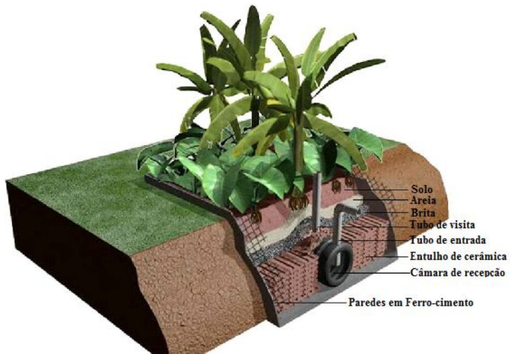
Figura 03 – Esquema do Tanque de Evapotranspiração (Fonte: GALBIATI, 2009).
