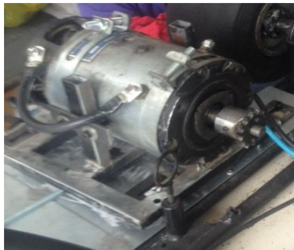
Figura 4 - Suporte de fixação do motor.
