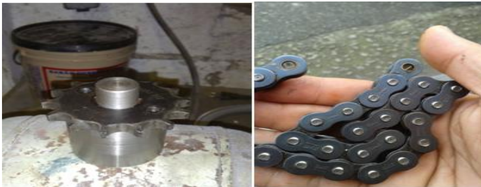
Figura 6 - Adaptador do eixo do motor e corrente de transmissão.
