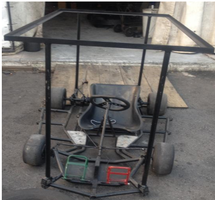
Figura 3 - Veículo com suporte do painel fotovoltaico.
