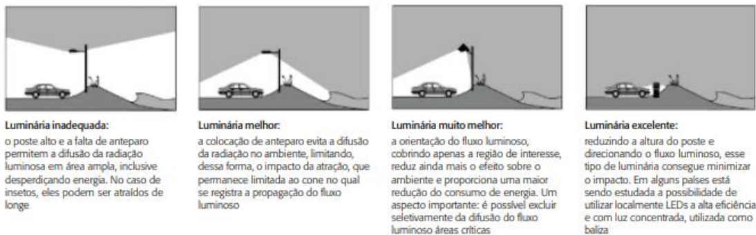
Figura 4 – Controle radiação luminosa
