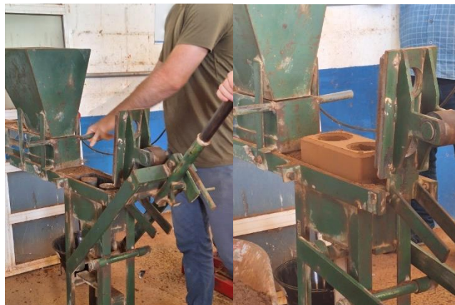
Figura 4 – Processo de produção do tijolo solo-cimento na máquina manual
