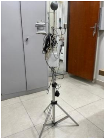
Figura 3 – Modelo de estação meteorológica usada para monitoramento microclimático.
