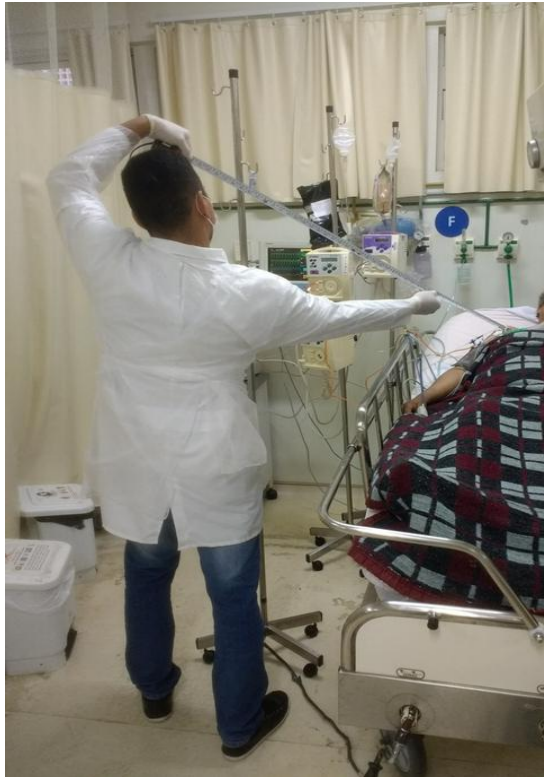
Figura2. Posicionamento do dosímetro a 1m do paciente no ambiente de UTI.
