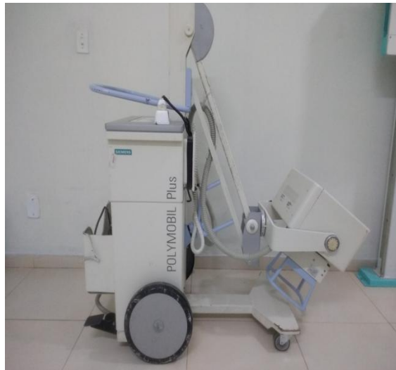
Figura 1. Equipamento de Aparelho de raios x móvel marca SIEMENS, modelo POLIMOBIL PLUS.
